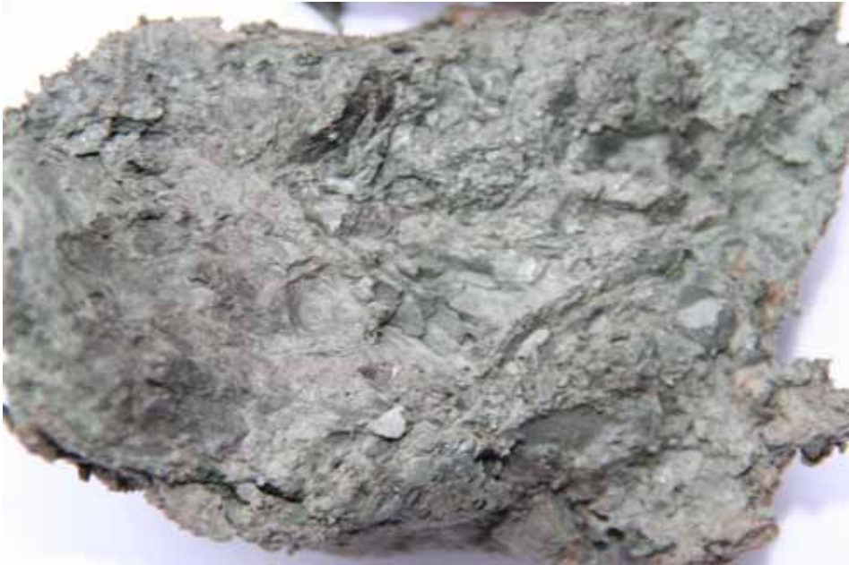
Fot. 1. Próbką iłolupka z wyraźną laminacją pochodzącą z rejonu budowanego zbiornika wodnego Świnna Poręba
