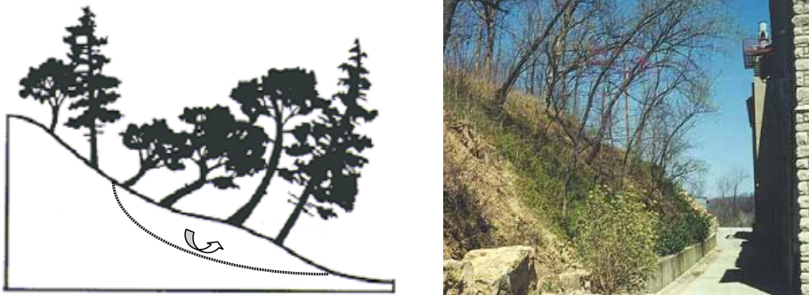
Rys. 2. Przykład charakterystycznego układu roślinności na skarpie, wskazujący na zagrożenie osuwiskiem
