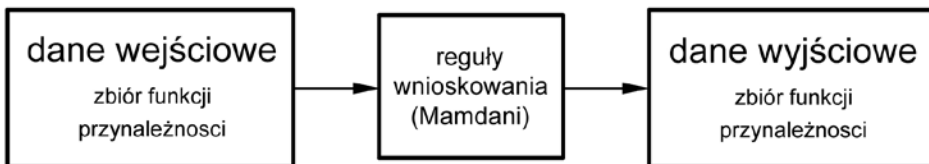
Rys. 1. Zasada wnioskowania rozmytego wg modelu Mamdaniego.
