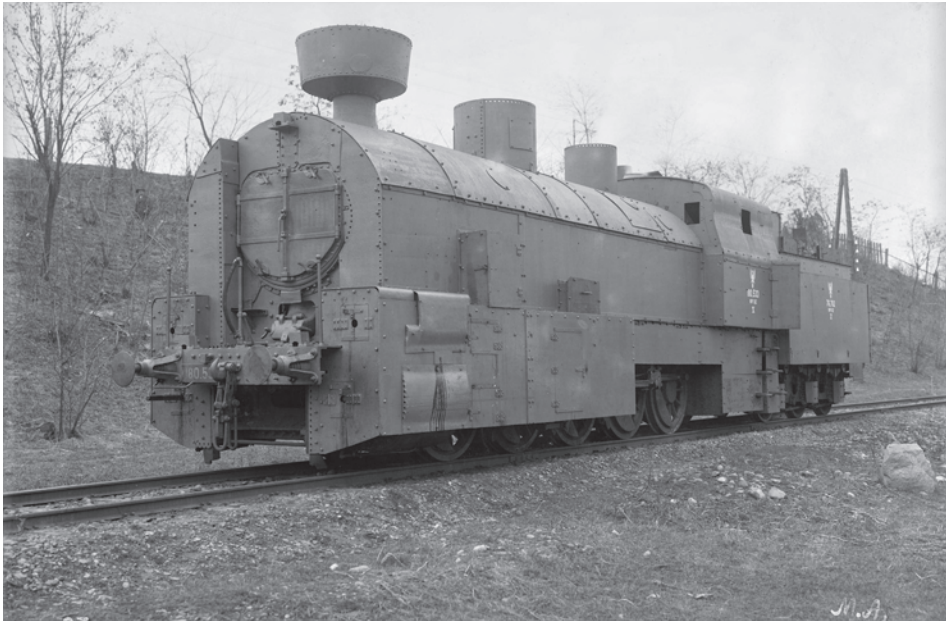
Fot. 9. Parowóz pancerny nr 180.533 (Wiener-Neustadt, nr fabr. 4929/1909) „Nowy Sącz X” z tendrem 76.702 opancerzony w Warsztatach Głównych w Nowym Sączu w kwietniu 1919 r. dla PP 3 „Lis-Kula”
